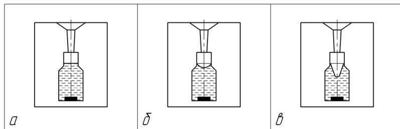
Рис.27. Варианты работы магнитной мешалки.
