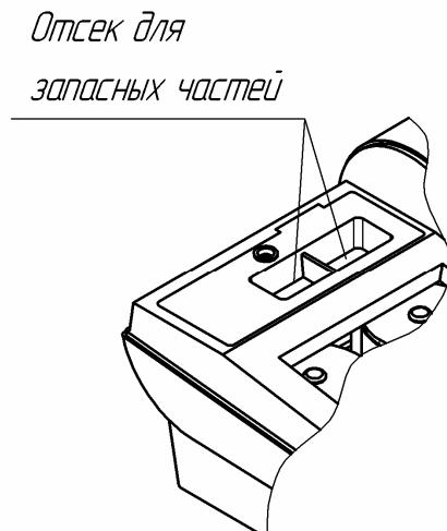
Рис.11. Вид отсека для запасных частей.
