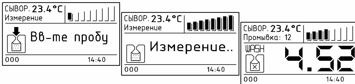
Рис.34. Сообщение дисплея при работе с сывороткой.
