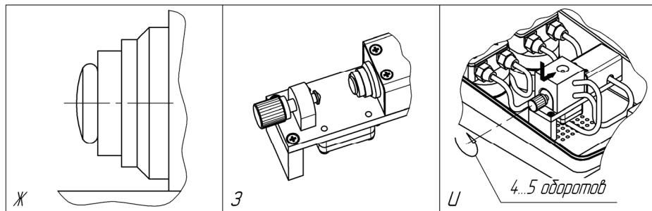
Рис.25. Контроль установленной мембранны. Установка измерительной ячейки.
