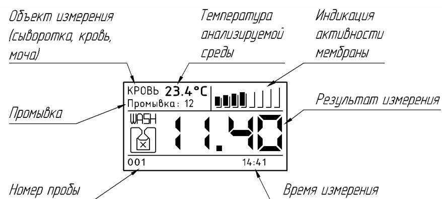
Рис.14. Сообщения дисплея в различных режимах.
