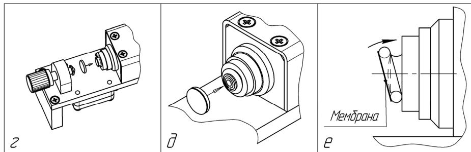
Рис.24. Установка мембранны на датчик.
