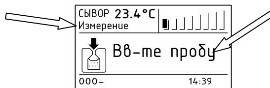
Рис.32. Индикация готовности анализатора к измерению в пробах.
